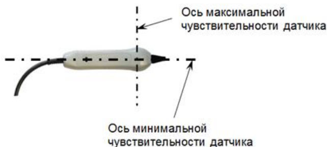
Рисунок А.2. Оси чувствительности датчика MED-127.
