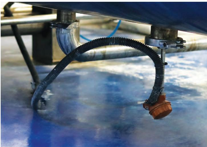
В нижнюю часть установки вмонтирован термометр сопротивления ТС-145-100М.В4.\120ГП и подключен к ИС-203.3
