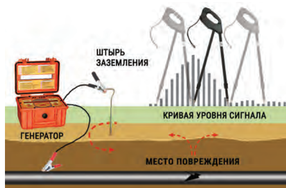
Контактный способ поиска мест повреждений кабеля
